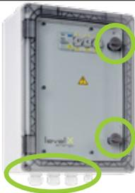
Vor der Installation der Blackout-Box müssen beide Drehriegel zum Verschluss des transparenten Front-Deckels sowie die 4 Stk. Anbauerschraubungen für die Kabeleinführungen montiert werden. Die Einzelteile sind im Beipackbeutel beigelegt.
